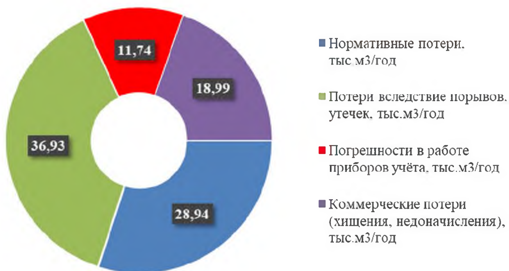
Рисунок 5 – Структурные составляющие потерь питьевой воды при ее производстве и транспортировке
